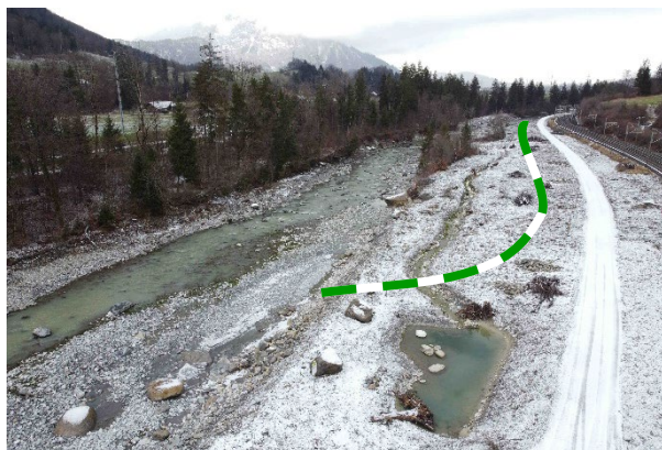
Mit BESB_T und BESB_F bewertete Aufweitung und Erosionsparzelle (dunkelgrün) beim WKW Augand.
