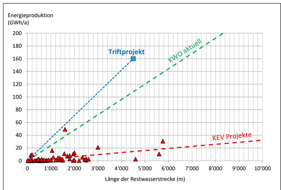
**Abbildung 4: Vergleich Triftprojekt mit KEV-Projekten anhand des Verhältnisses von Stromproduktion (GWh/a) und damit verbundener Länge der Restwasserstrecke. Blaues Quadrat = Triftprojekt, rote Dreiecke = KEV-Projekte (BFE 2015).**
